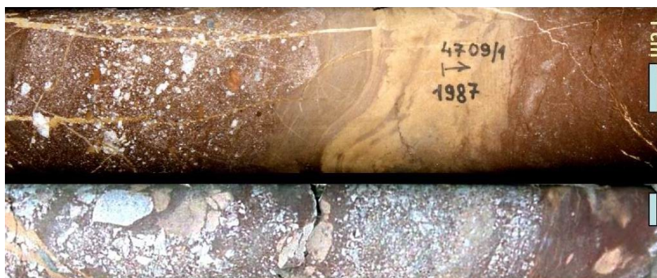
9. ábra: A BAF és a Cserdi Formáció összefogazódása a 4709 sz. érckutató fűrésban
