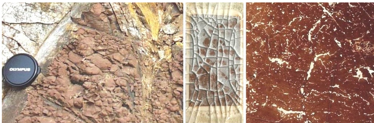
5. ábra: A Bodai Agyagkő típusos aleuritós agyagkő – agyagos aleurolit közötti típusának jellemzője a gumós mállás (balra, bodai alapszelvény), a duzzadó agyagásvány-tartalom (középen) és a talajosodásra utaló zavart mikroszerkezet (jobbra, Alfa-vágat, L-1 fűrés, a kép élhosszúsága 5 mm)
