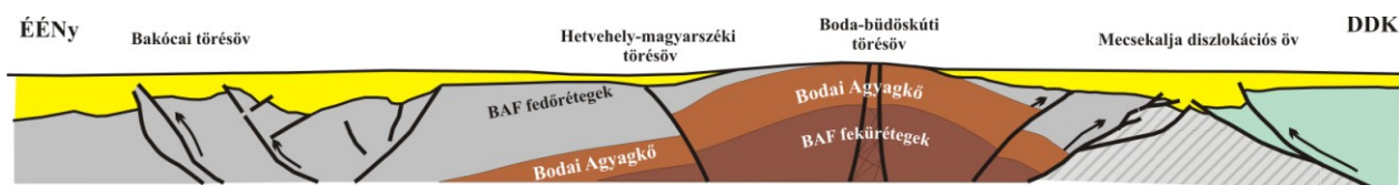
2. ábra: ÉÉNy-DDK csapású földtani szelvény a nyugat-mecseki antiklinálison keresztül (1. 1. ábra, Konrád 2012 [12])
