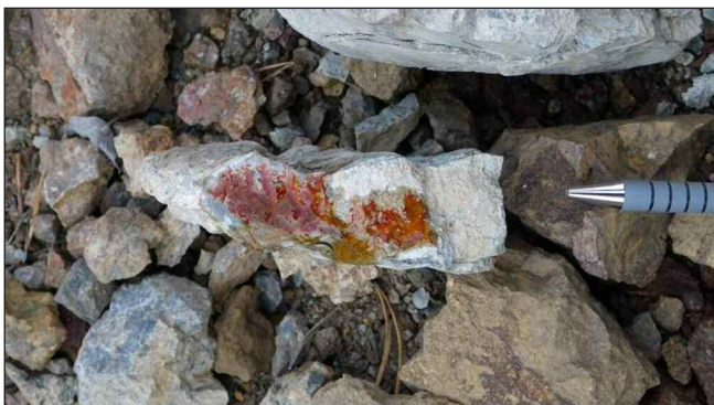
5. ábra: Nem-szulfidos cinkásvány kimutatására alkalmas kolorimetriás reakció. A vörös szín a cink több %-os jelenlétét jelzi.
