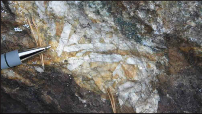
7. ábra: Durvakristályos barit a rúd-barit-telér kifejlődéséből, Andrassy-I. külfejtés.
