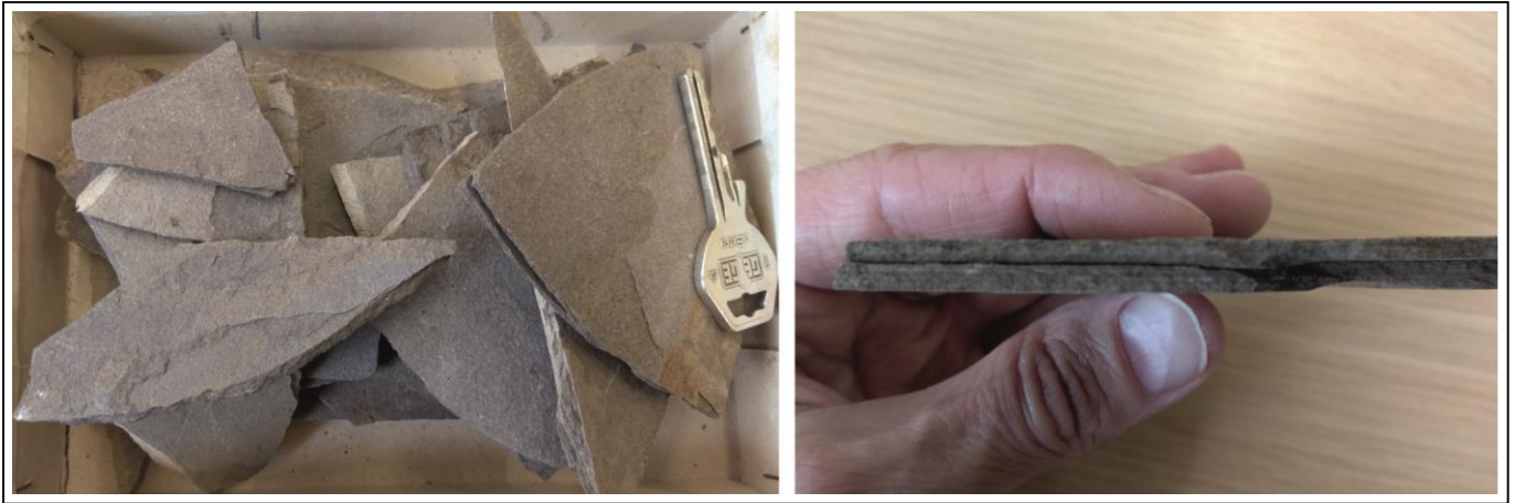
10. ábra – A Rákavölgyi Aleurolit Formáció bitumenes, lemezes agyagmárgájának makroszkópos megjelenése. A kőzet a felszíni mállás hatására barnás árnyalatú, a lemezek felszíne gazdagon csillámos.
